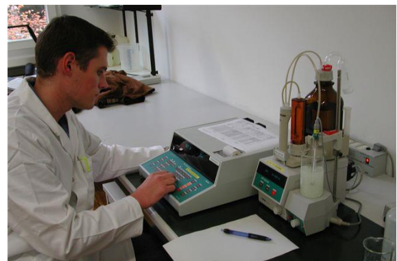
Hier wird Silber mittels Potentiometer bestimmt.
