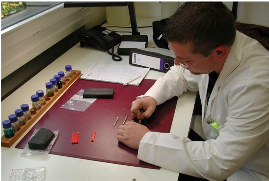
Für die genaue Analyse wird das zu prüfende Edelmetallmuster zuerst eingewogen, dann kupelliert.
