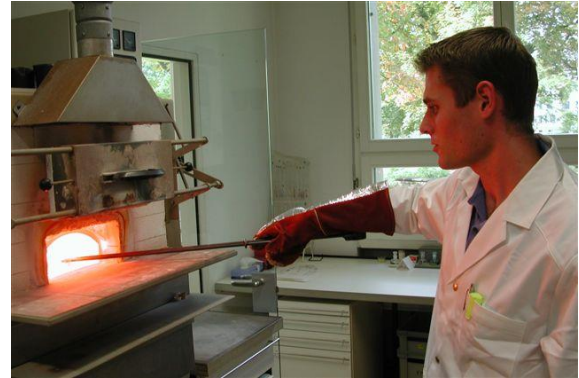
Für die genaue Analyse wird das zu prüfende Edelmetallmuster zuerst eingewogen, dann kupelliert.
