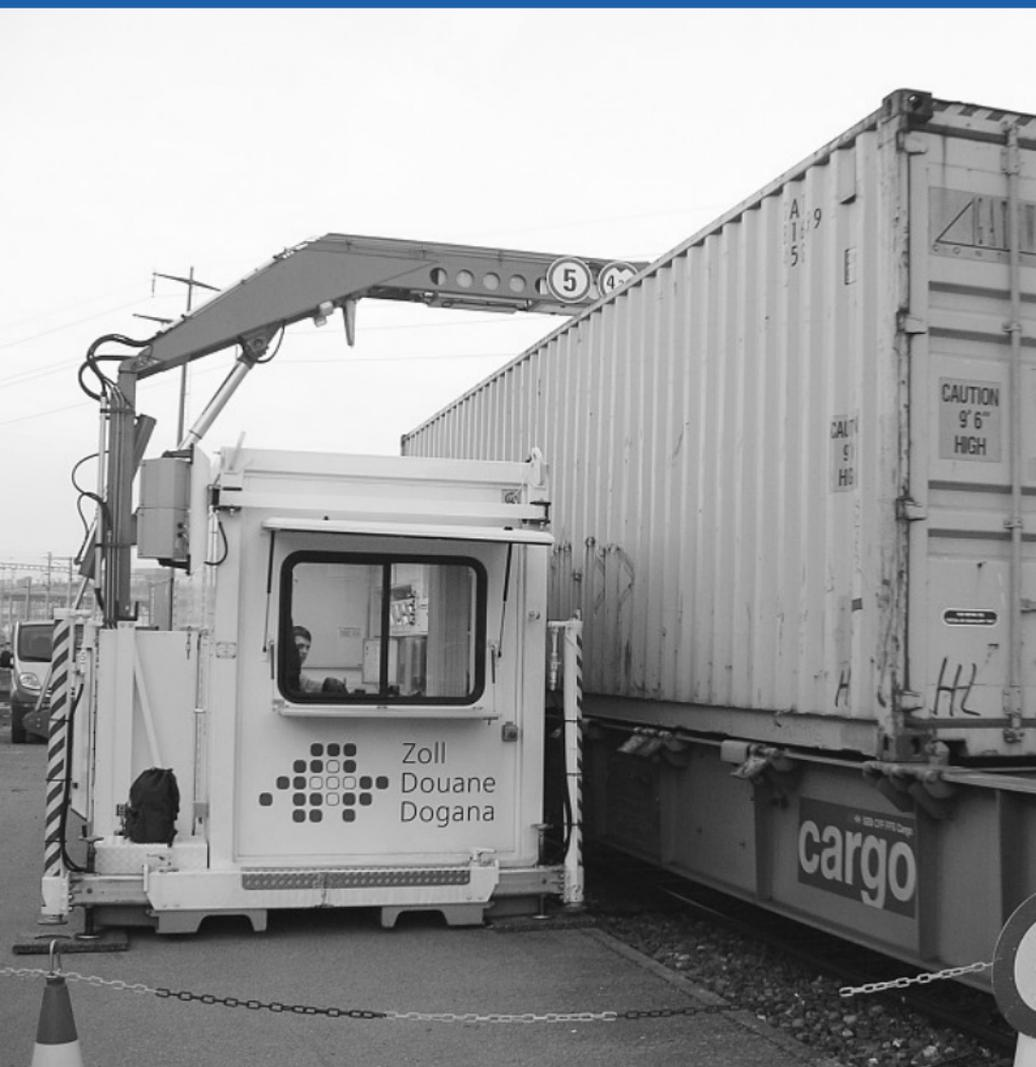
Dank zwei mobilen Scannern kann der Zoll LKW-Ladungen effizient kontrollieren und so Standzeiten an der Grenze minimieren. Die Scanner werden aber auch im Grenzraum bei kombinierten Polizei- und Zollkontrollen im Schwerverkehr eingesetzt. Seit Sommer 2006 können auch Bahnwaggons und Container gescannt werden.
